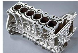
6 Gießzellen wurden entwickelt und gebaut. Sie produzieren pro Jahr rund 550.000 Stück NG6 Kurbelgehäuse mit einer Taktzeit von je 128 Sekunden. Die Druckgußmaschine besitzt eine Verschlusskraft von 4000 Tonnen. Pro Zelle existieren 13 unabhängige Steuerungen die von der übergeordneten Leitsteuerung als eigentliches "Gehirn" koordiniert und gesteuert werden, welche auch den Kontakt zur BMW-ZLT (Zentrale Leittechnik) hält.
